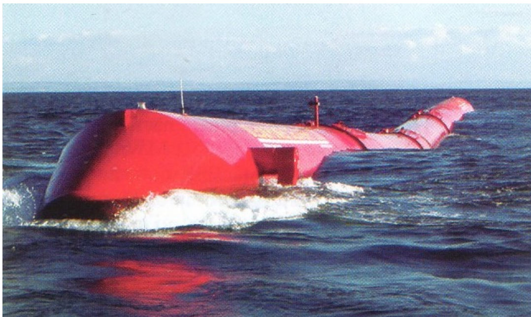
Mareomotor para el aprovechamiento de la energía de las olas y mareas
