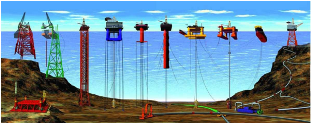
Estructuras para la extracción de petróleo y gas costa afuera
