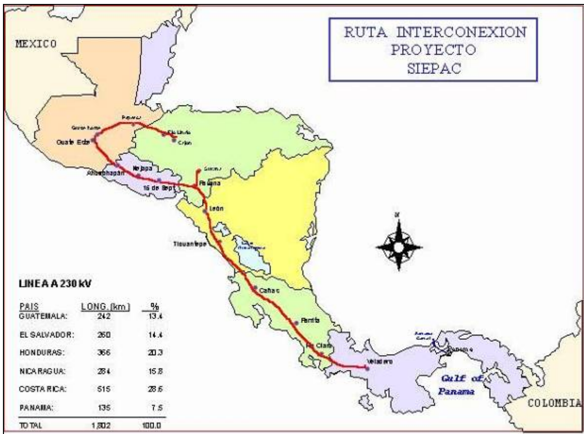
Sistema de interconexión eléctrica para América Central
