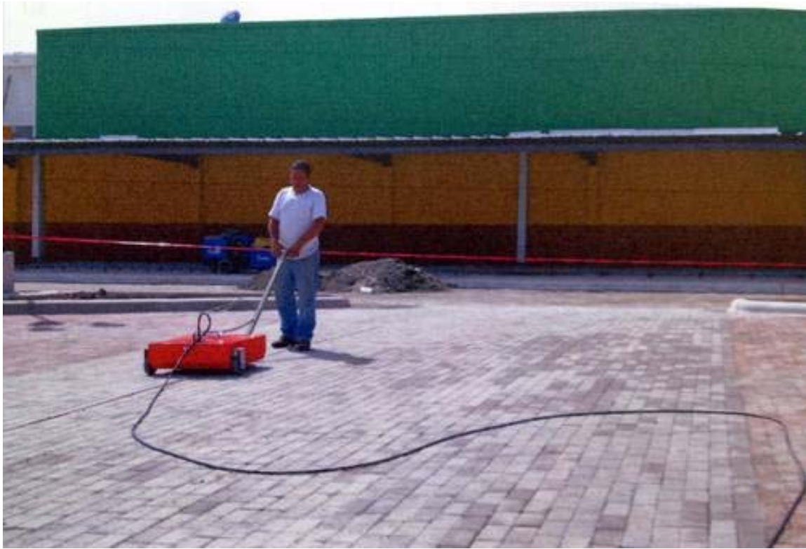
Estudios con georadar después de la construcción de Wal-Mart en Teotihuacan FOTO: J. Ortega
